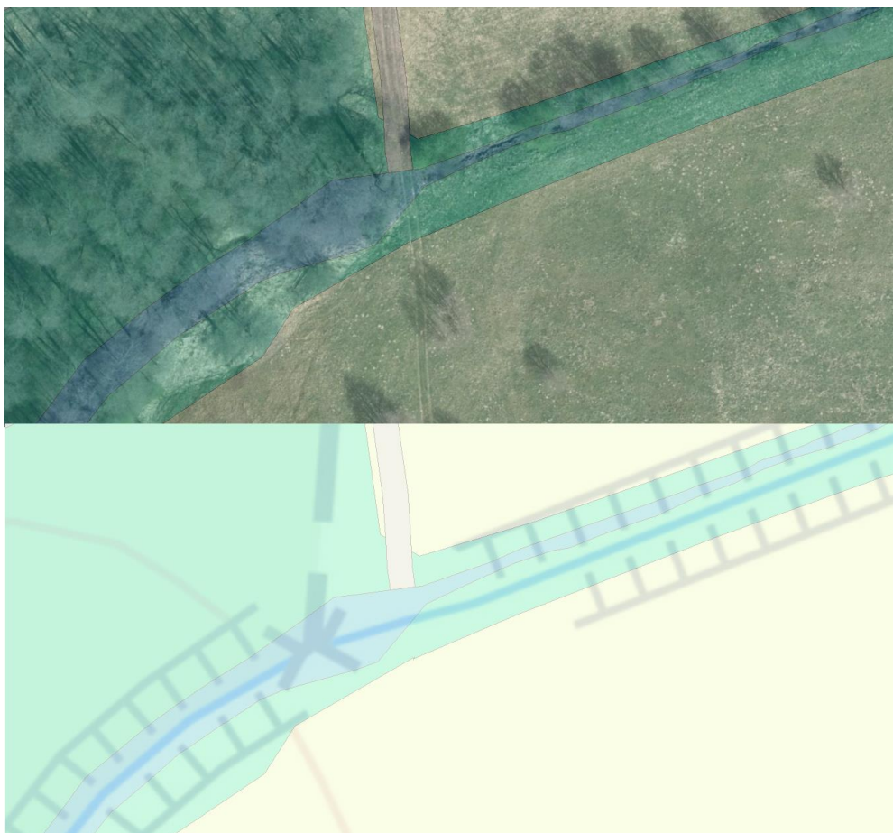
Obrázek 4: V místech, kde koryto není identifikovatelné nad žádným z dostupných ortofot z důvodu průběhu v lesním porostu je průběh vedení a šířka koryta přizpůsobena základní mapě a identifikovatelným profilům šířky.
