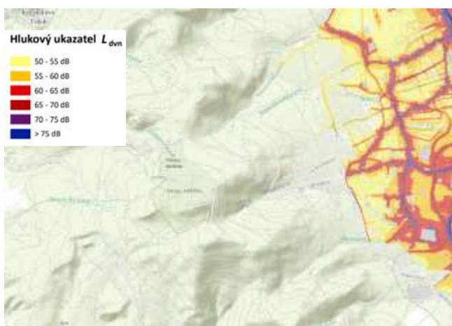
Obr. 19 Strategická hluková mapa 2017 pro hlukový ukazatel L_{dvn} pro Aglomerace celek (den), zdroj portal.mzcr.cz
