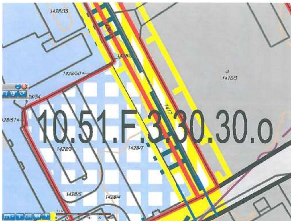
Komunikaci (červené čáry) posunout do leva tak, aby komunikace opustila pozemek 1417 a byla na pozemku 1428/7. V případě realizace by tak pozemek 1417 zůstal nedotčený stavbou. Kam posunout jsem dole namaloval 2 modrými čarami. Při tomto posunutí by komunikace zasáhla do požární nádrže v horní části obrázku, ta je ale vyjmuta ze systému požární ochrany. Voda z nádrže byla nahrazena novým hydrantem.
