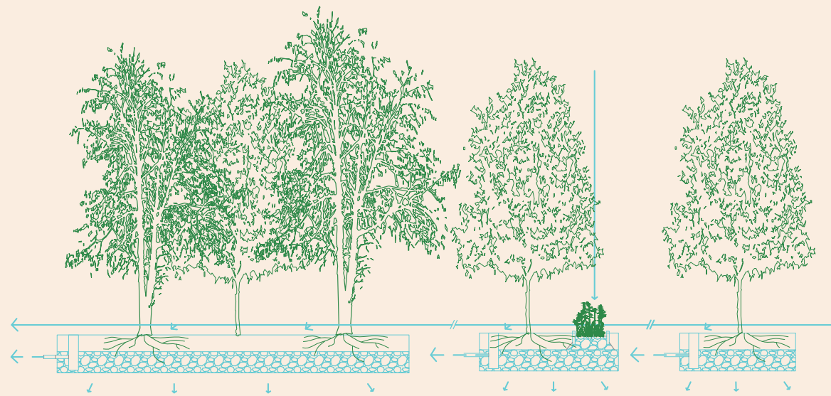
1. systém propojeným podzemních rýh s retenční kapacitou
