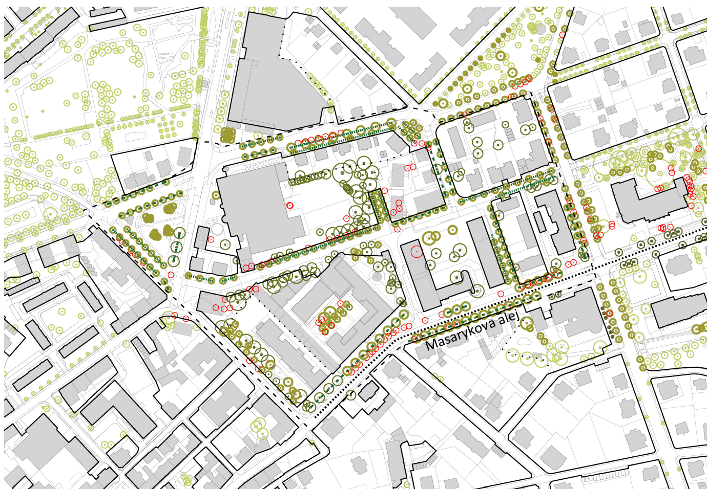
schéma výsadby (červená: kácené stromy, zelená: stávající stromy, zelená tlustá: nově navržené stromy, černá čárkovaná: osa Masarykovy aleje)
